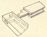
Fig. 115-Shouldered Tenon Joint
